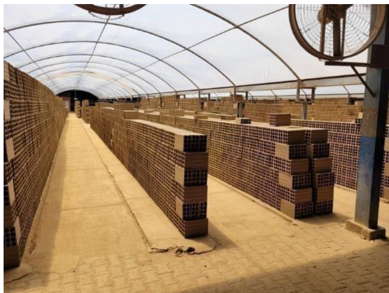
Figura 1.3- Blocos cerâmicos verdes em processo de secagem, antes da etapa de queima.
