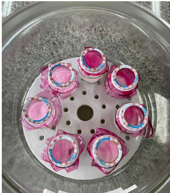
Figura 2: Cápsulas seladas com o filme dispostas no dessecador.
