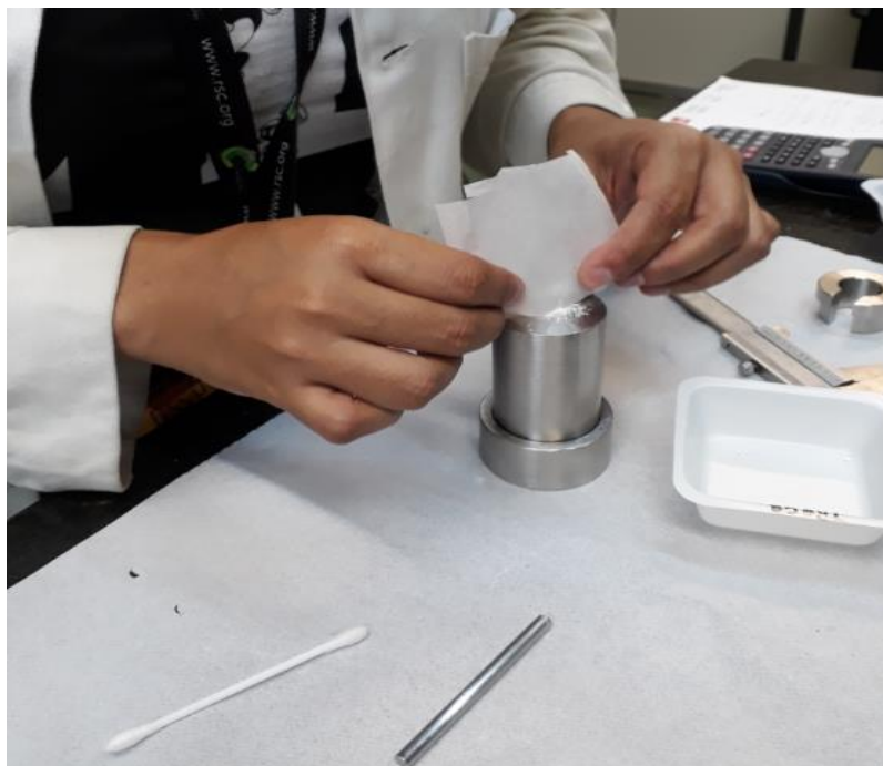
Figura 15. C 3 - Demonstração de material prensado para obtenção dos comprimidos de Cada amostra: ZnAl-GABA-HDL-TI, ZnAl-GABA-HDL-TH e Zn-GABA-SBL.
