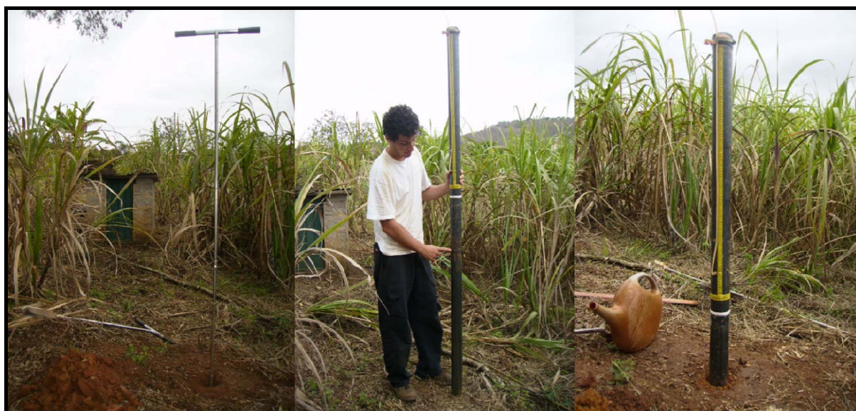
Figura 3 – Ensaio de permeabilidade, com destaque para a cota superficial apontada.
