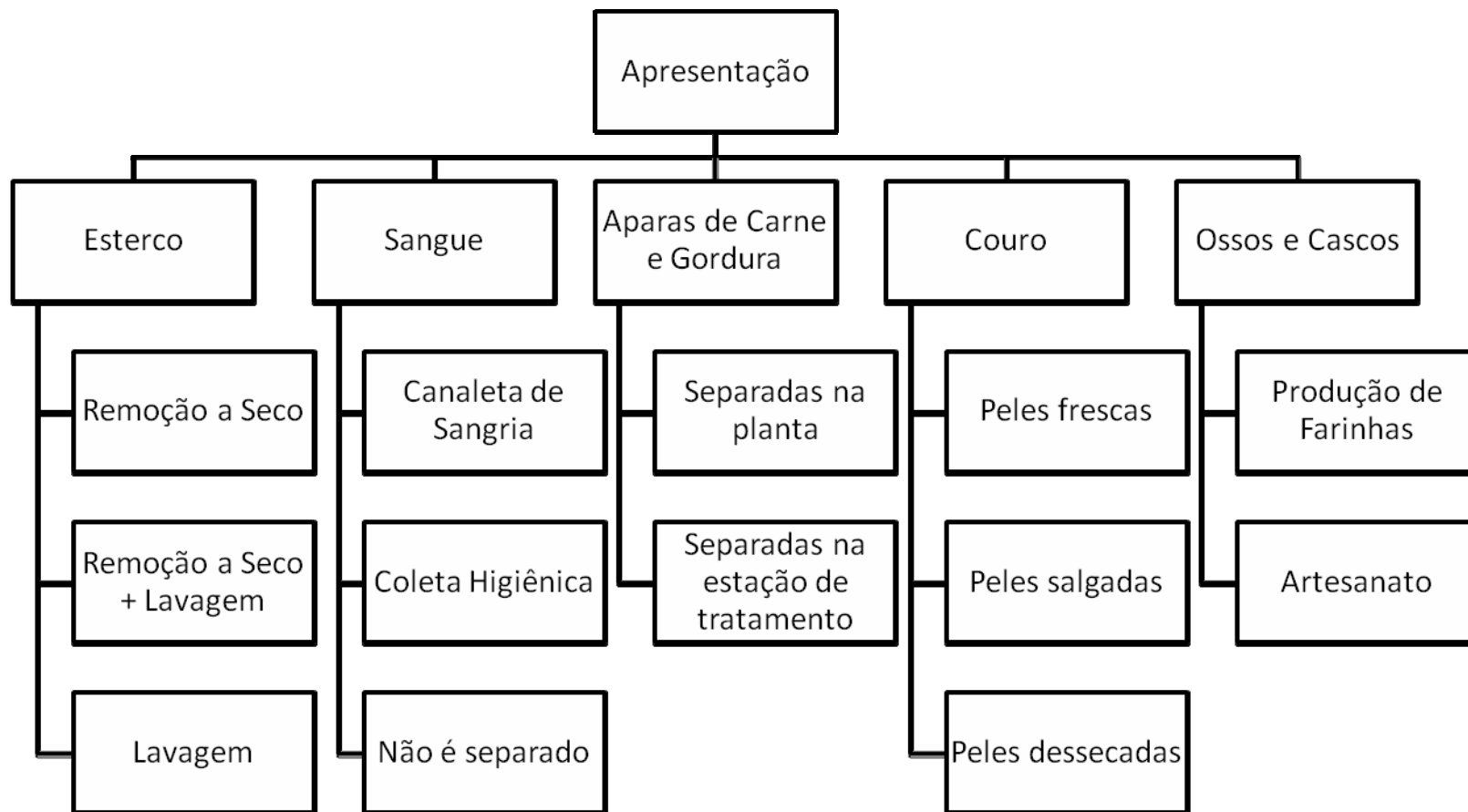
Figura 16 - Estrutura básica do sistema de apoio à decisão para gerenciamento de subprodutos
