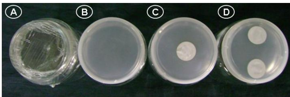
Figura 1. Tipos de vedações usados na propagação in vitro de Vitis vinifera x Vitis rotundifolia . A) filme plástico de PVC (PVC), B) tampa plástica de polipropileno (TN), C) tampa plástica de polipropileno contendo um furo cobertos por membranas permeáveis a trocas gasosas (TMF1) e D) tampa plástica de polipropileno contendo dois furos cobertos por membranas permeáveis a trocas gasosas (TMF2).
