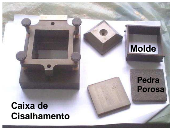
Figura 21. Célula de ensaio de cisalhamento direto.
