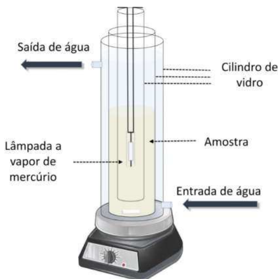
Figura 1. Ilustração do fotoreator utilizado nos ensaios fotocatalíticos.
