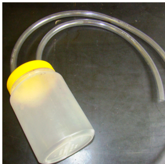
Figura 7: Coletor utilizado para remoção da água do copo central das bromélias, tamanho 5 x 10 cm, volume 500 mL.
