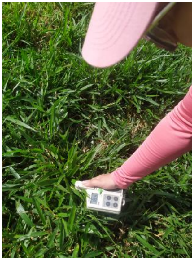
Figura 3. Coleta em campo utilizando o SPAD.
