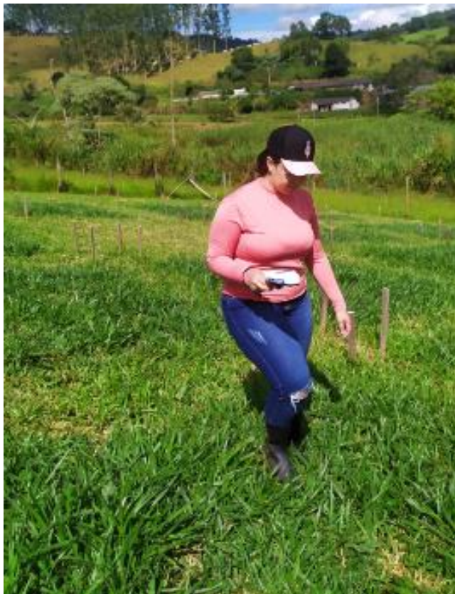
Figura 5. Coleta da variável espectral utilizando GreenSeeker.
