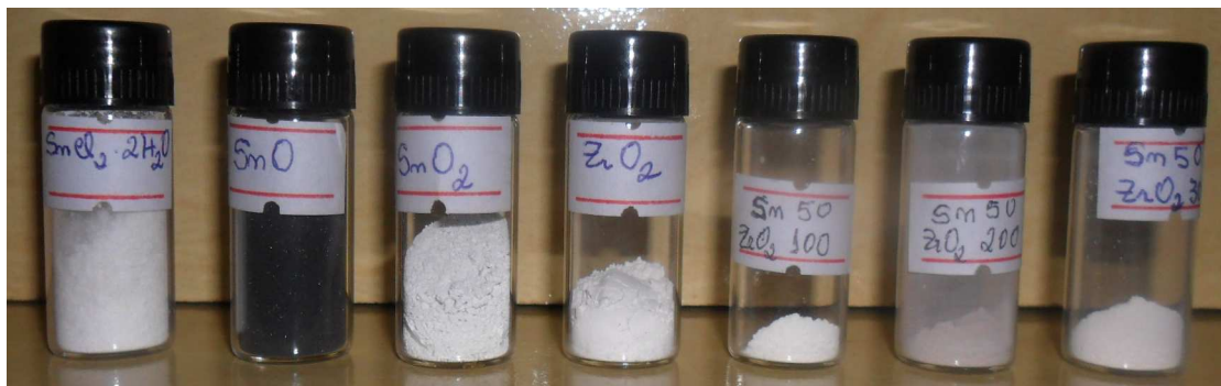
Figura 7: Fotos cloreto de estanho, óxido de estanho II, Oxido de estanho IV, Oxido de Zircônio e dos compósitos de \text{SnCl}_2\text{50/ZrO}_2 - 100^\circ\text{C} , \text{SnCl}_2\text{50/ZrO}_2 - 200^\circ\text{C} e \text{SnCl}_2\text{50/ZrO}_2 - 300^\circ\text{C} respectivamente.
