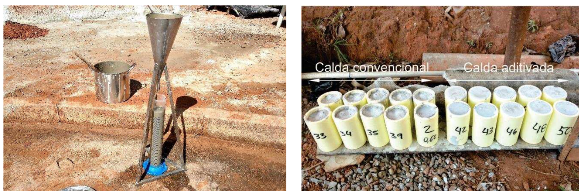
Figura 57 – Teste de fluidez e moldagem de corpos de prova em campo
