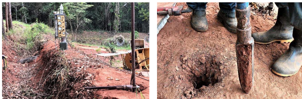
a) Esquema de montagem do PMT (furo 1); (b) Detalhe do trado manual cônico.
