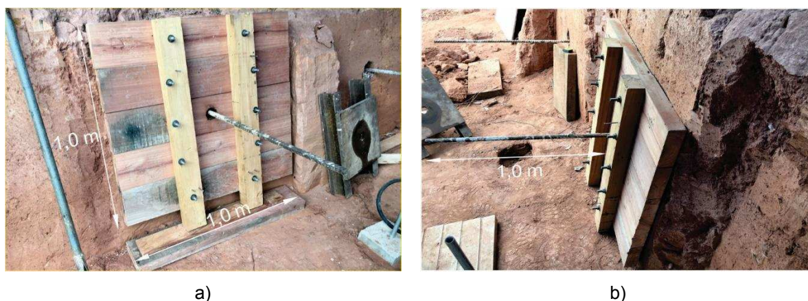
Figura 60 – Painel rígido de madeira e trecho livre da barra
