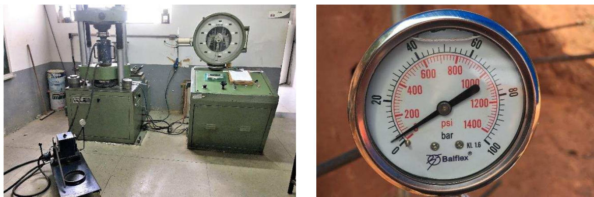
Figura 62 –Calibração do macaco hidráulico e manômetro analógico
