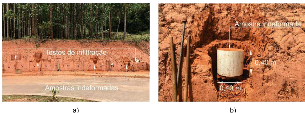
(a) Vista dos pontos de retirada das amostras indeformadas e dos testes de infiltração; (b) detalhe da retirada de amostra indeformada cilíndrica.
