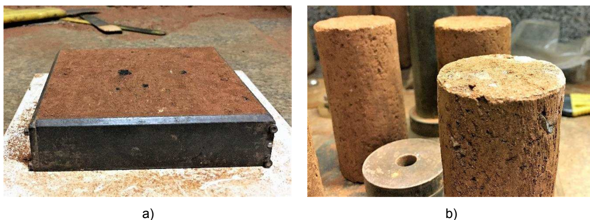
(a) Moldagem para ensaio de cisalhamento direto; (b) moldagem para ensaio de compressão triaxial.
