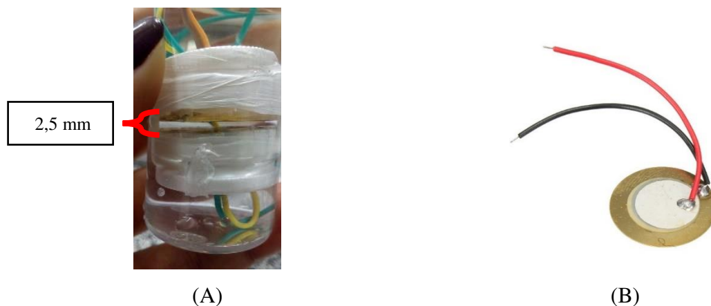
Figura 9 - (A) Primeira célula de som confeccionada para o espectrômetro de som; (B) Transdutor piezoelétrico; (C) Desenho esquemático da célula de som.
