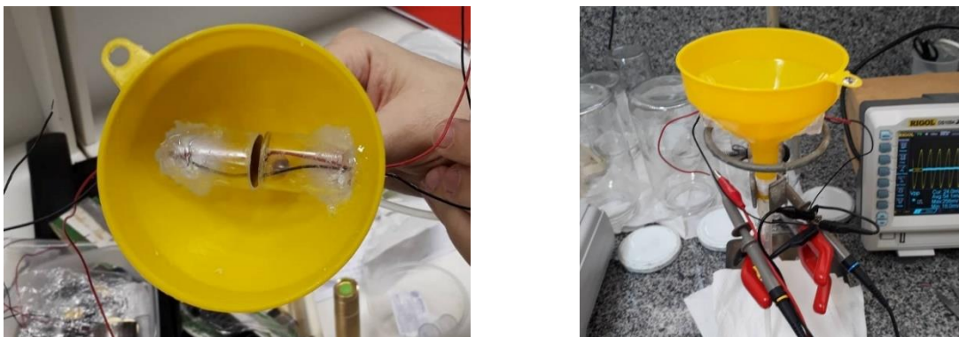
Figura 13 - Célula de som construída para o sistema do espectrômetro de som com o osciloscópio.
