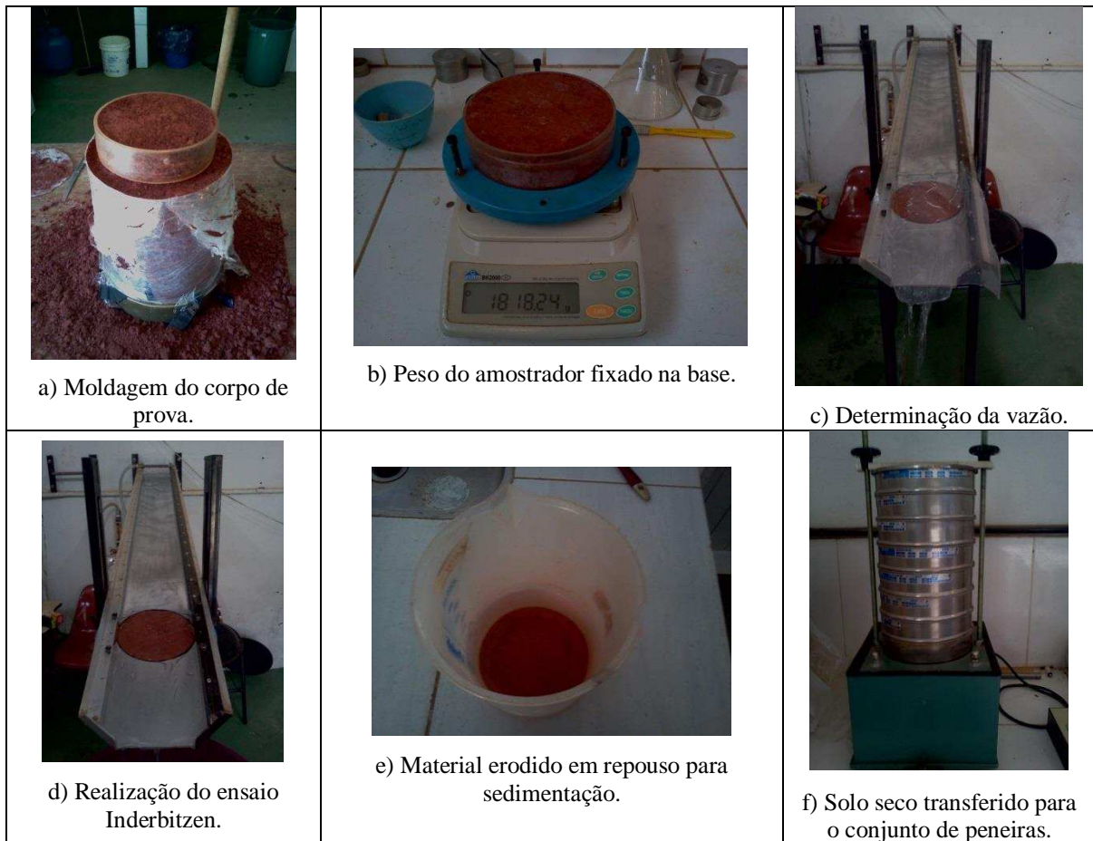
Figura 2. Detalhe da realização do ensaio de Inderbitzen e da coleta e peneiramento do material erodido.
