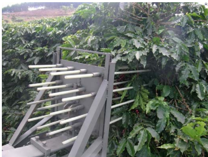
Figura 4.2 - Posicionamento das hastes no dossel do cafeeiro.
