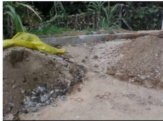
Figura 4 - Disposição da mistura lodo + cal em leiras cobertas com lona plástica, Viçosa-MG
