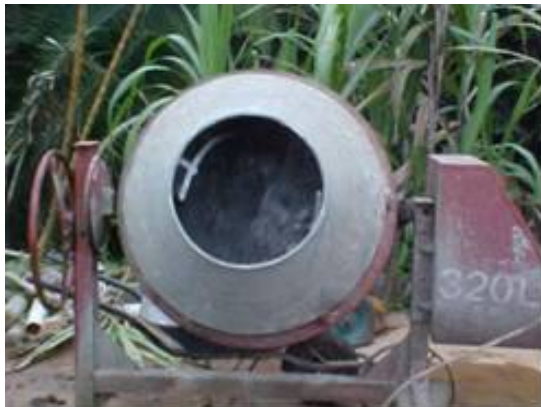
Figura 3 - Caleação do lodo da ETE Viçeira com uso de betoneira, Viçosa-MG
