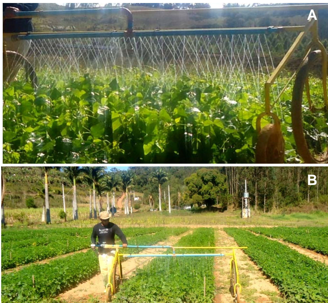
Figura 10. Equipamento de simulação de aspersão com tubo de PVC perfurado, usado na irrigação (A) e sua operação (B).
