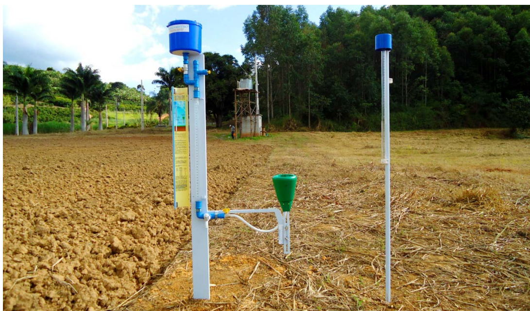
Figura 12. Irrigâmetro instalado no campo.
