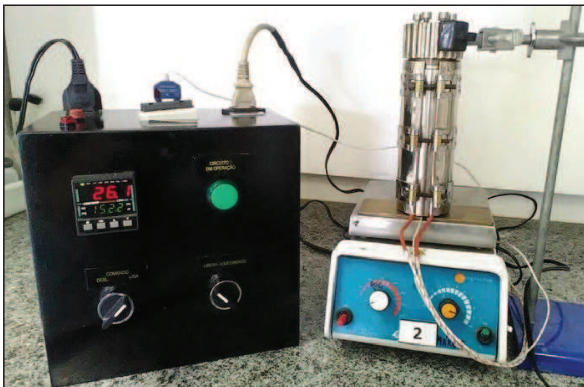
Figura 7: Sistema em funcionamento. Caixa preta: controlador de temperatura digital, regulando a liberação do aquecimento. Fio branco: termopar inserido na parte inferior do cilindro de aço. Chapa de aquecimento apenas para sustentação.
