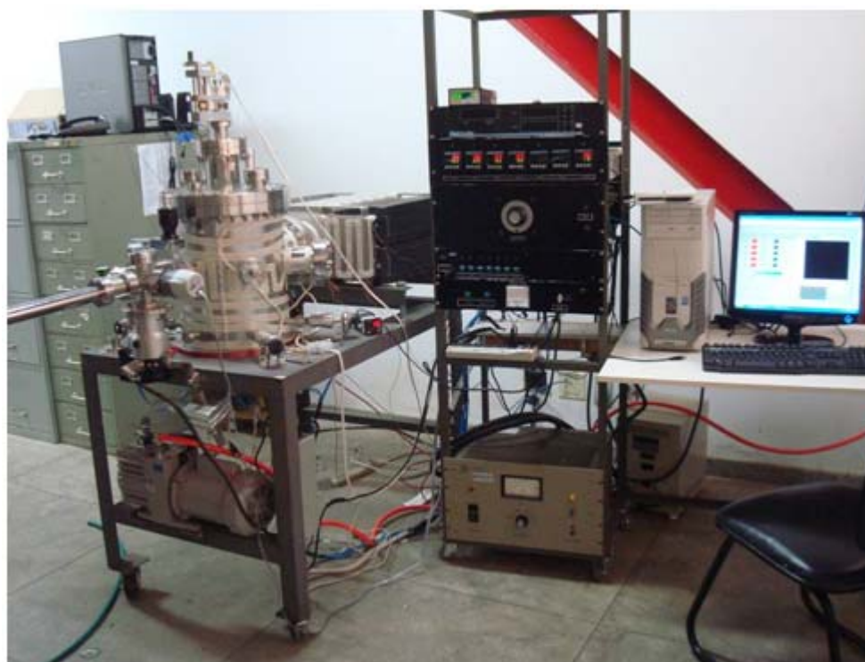
Figura 6. 1 – Sistema de MBE, construído no Departamento de Física da Universidade Federal de Viçosa.
