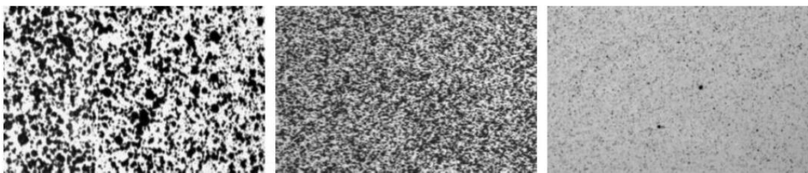
Figura 15 - Exemplos de três padrões aleatório aplicados na superfície do corpo de prova ensaiado.
