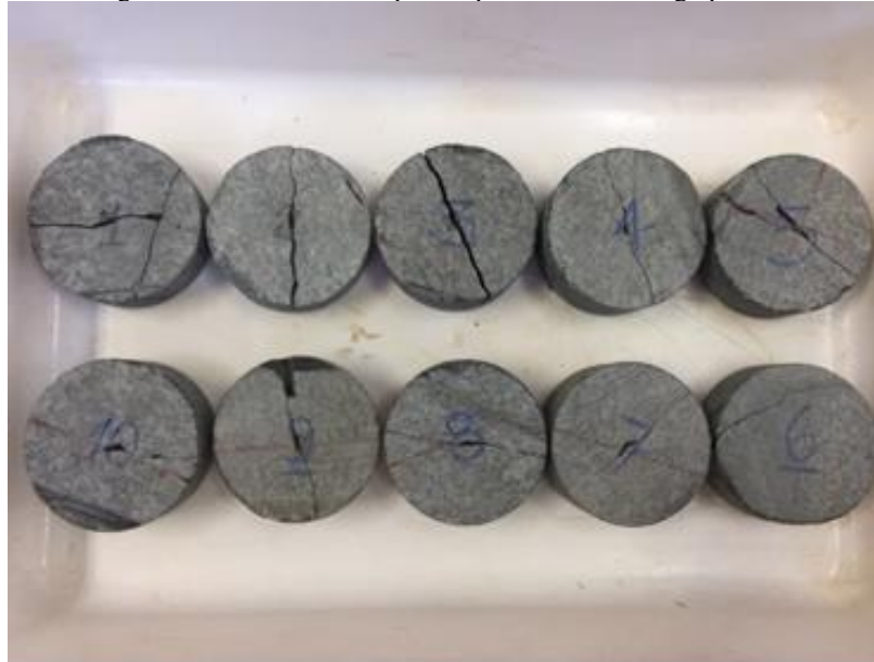
Figura 25 - Amostras rompidas após ensaio de carga pontual.
