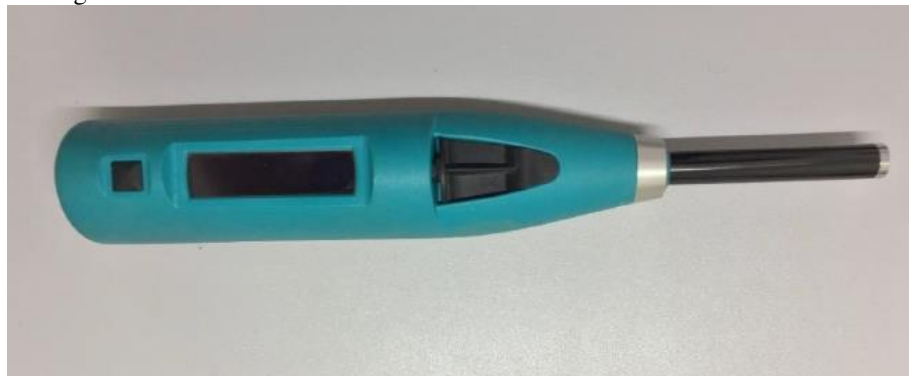
Figura 23 – Martelo de Schmidt utilizado durante os ensaios esclerométricos.
