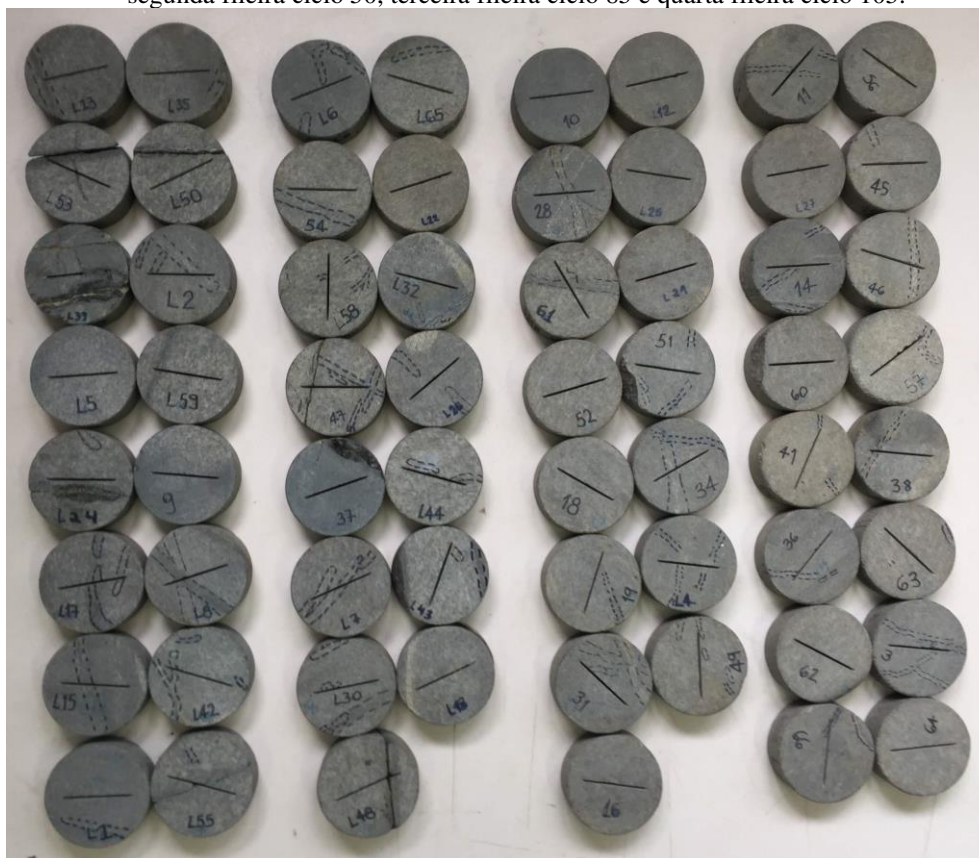
Figura 28 - Amostra após ciclagem água-estufa. Da esquerda para direita, a primeira fileira indica ciclo 20, segunda fileira ciclo 50, terceira fileira ciclo 85 e quarta fileira ciclo 105.
