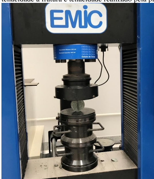
Figura 21 - Ensaio de tenacidade à fratura e tenacidade realizado pela prensa servo-controlada.
