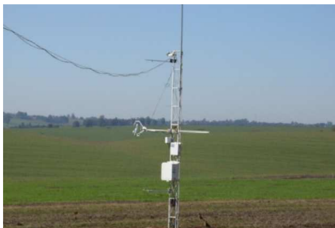
Figura 4 - Sistema Eddy Covariance e estação meteorológica automática (EMA) instalada acima da cultura da soja numa torre micrometeorológica.
