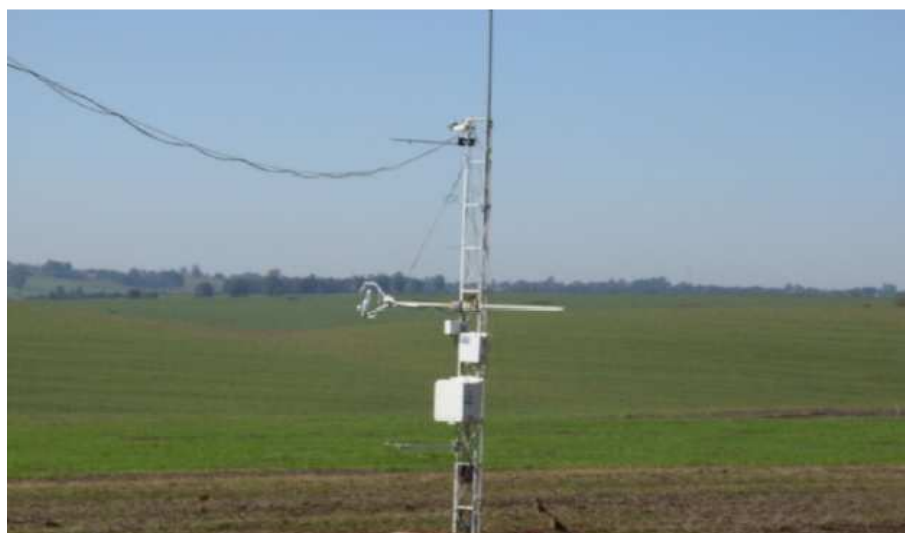
Figura 5 - Sistema Eddy Covariance estação meteorológica automática (EMA) instalada acima da cultura da soja em torre micrometeorológica.
