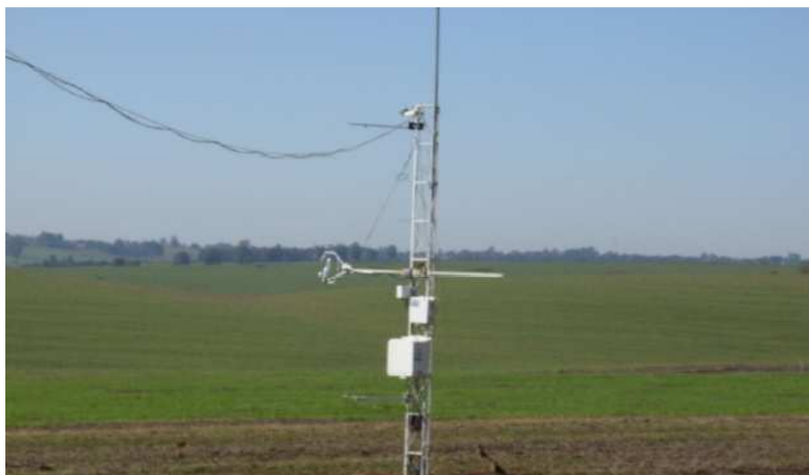
Figura 2 - Sistema Eddy Covariance e estação meteorológica automática (EMA) instalados acima da cultura da soja em torre micrometeorológica.
