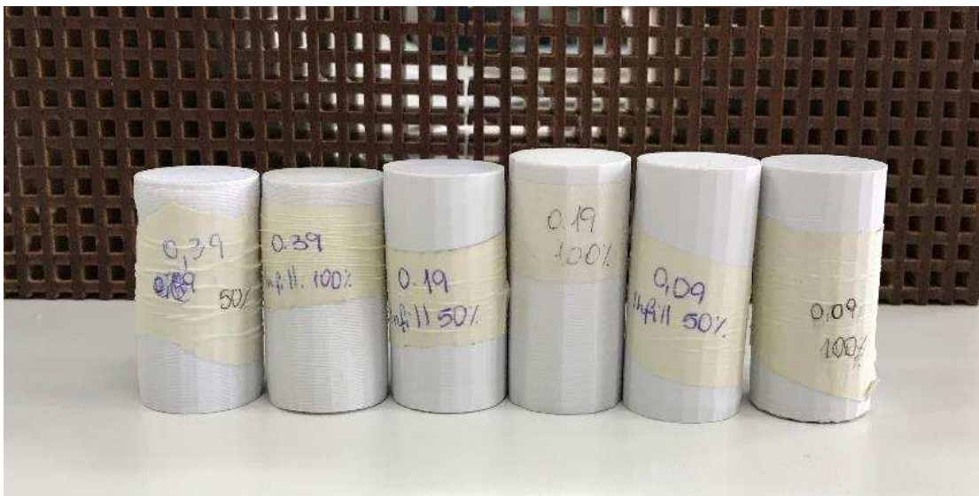
Figura 18: Vista frontal dos CPs de 5 cm após ensaio mecânico
