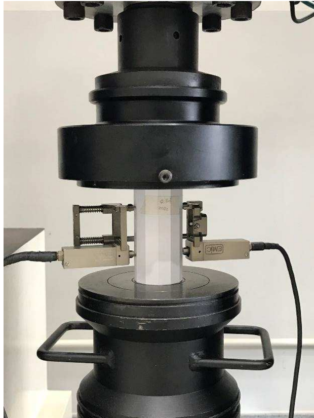
Figura 11: Extensômetros encaixados no CP para ensaio
