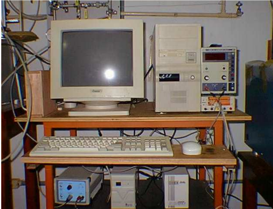
Figura 10 - Sistema de aquisição de dados do ensaio triaxial cíclico.
