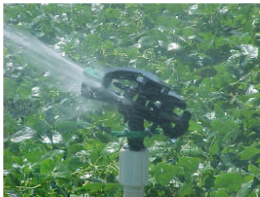
Figura 8 – Aspersor NAAN, modelo AG 427 em funcionamento.
