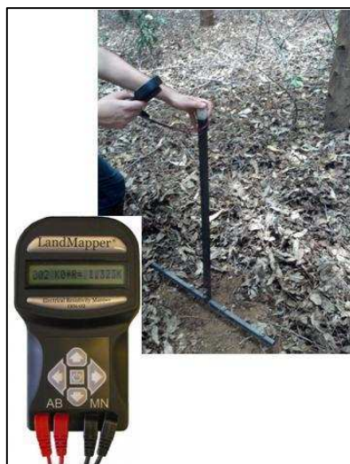
Figura 1.2. Medidor portátil de condutividade elétrica aparente (Landmapper), utilizado no mapeamento da variabilidade espacial do solo.
