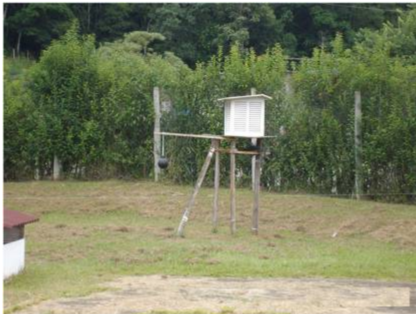
Figura 8 – Vista do abrigo meteorológico e, próximo a ele, o termômetro de globo negro
