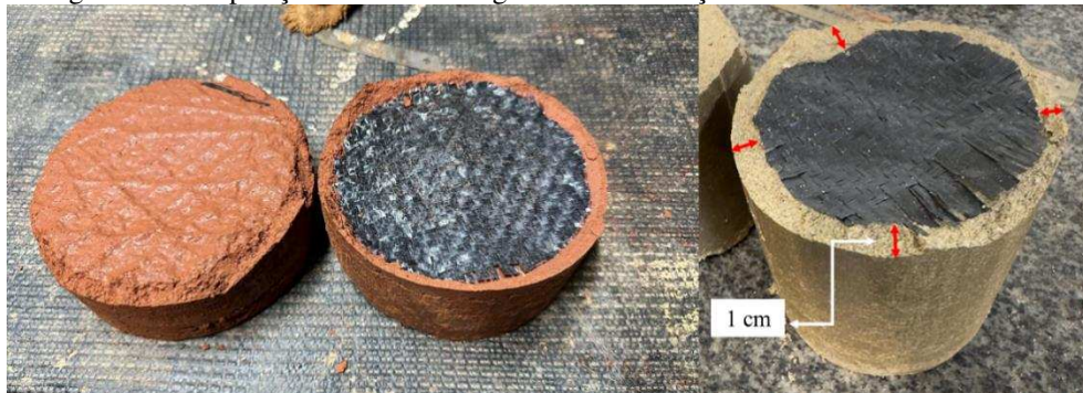
Figura 10 – Disposição e tamanho do geotêxtil de reforço inserido nos CPs moldados
