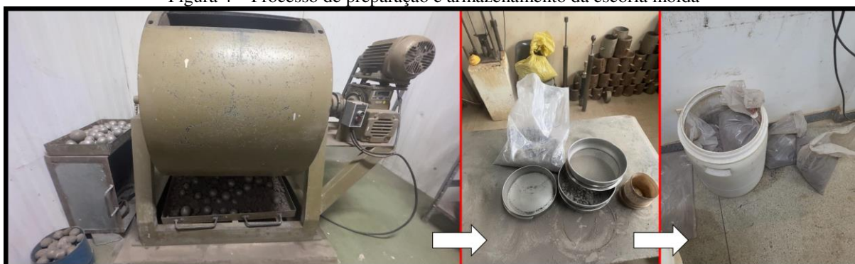
Figura 4 – Processo de preparação e armazenamento da escória moída
