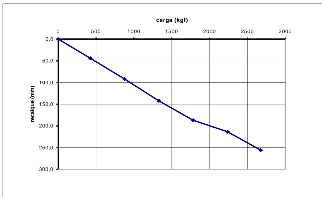
Figura 30 – Curva carga (kgf) versus recalque (mm) do segundo ensaio.
