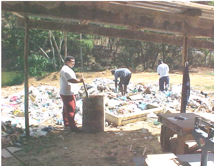
Figura 10 – Processo de quarteamento do RSU para ser feito a gravimetria.
