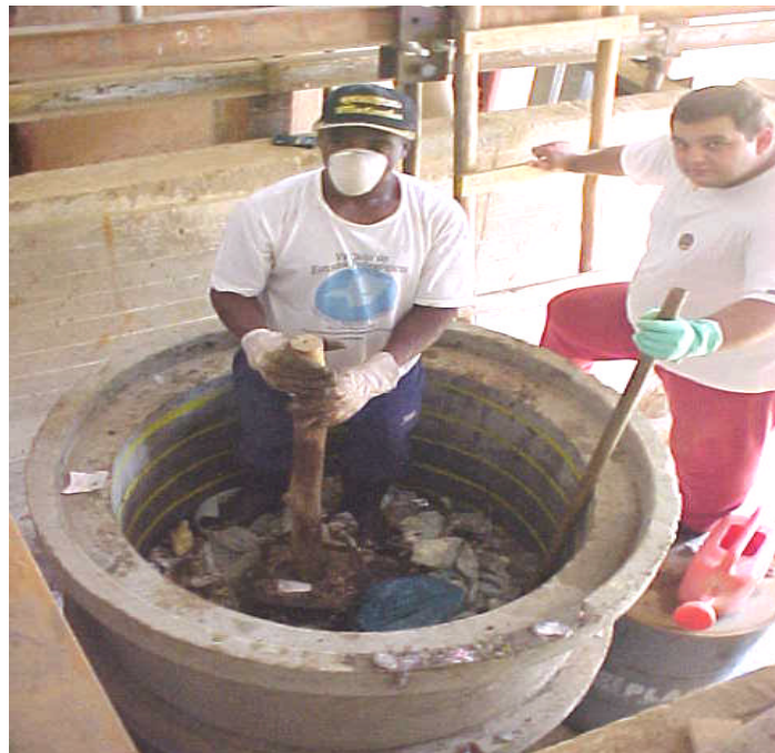
Figura 13 – Compactação do RSU na Célula.
