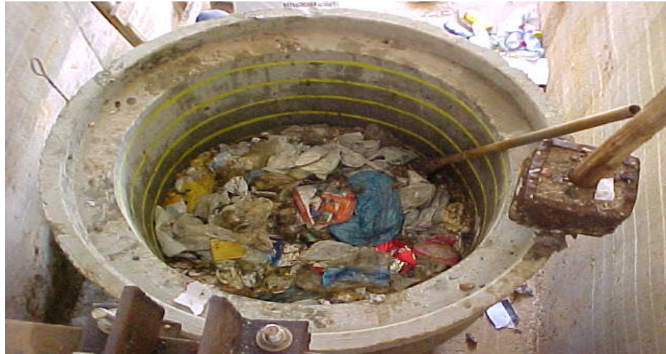
Figura 12 – Representação da disposição do RSU em camadas.
