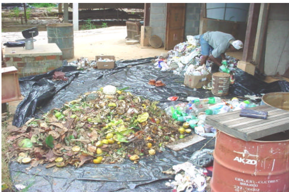
Figura 11 – Análise Gravimétrica dos RSU.
