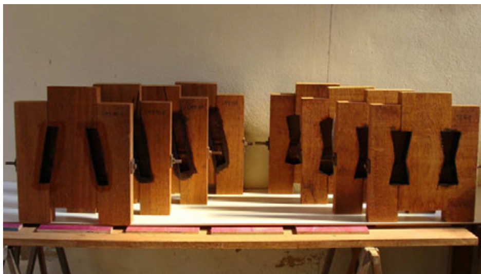
Figura C.1. Corpos-de-prova de ligação madeira-madeira, com três peças de madeira, com conectores de concreto em dentes simples e em dentes duplos.
