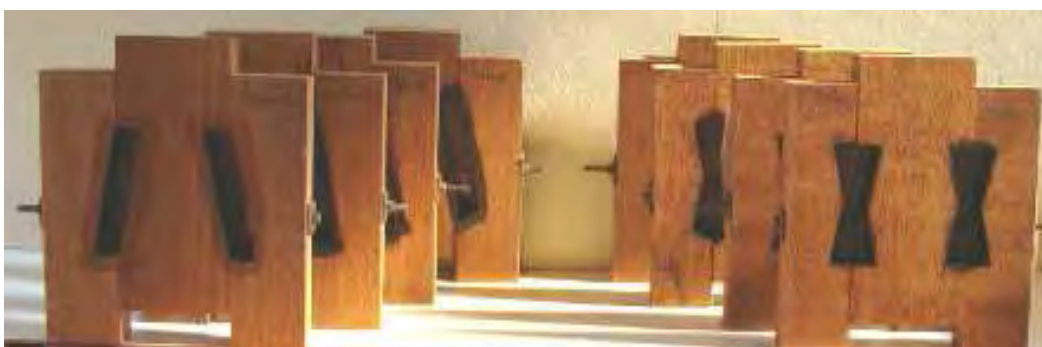
Figura 3.14. Corpos-de-prova de ligação com conectores de concreto entre três peças de madeira antes da concretagem.
