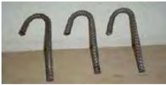
Figura 2.16. a) conectores de barra de aço com gancho; b) dimensões relativas utilizadas nas ancoragens dos conectores. Fonte: Carvalho (2008).
