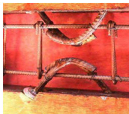
Figura 3.9. Corpos-de-prova com conectores de barra de aço em arco com fixação na madeira por cravação direta, com fixação por adesivo epóxi e com auxílio de placa de ancoragem e entalhe na madeira: a) Representação esquemática; b) Vista antes da concretagem das peças centrais; c) corte transversal esquemático e vista da ligação por pinos em arco, com chapa de ancoragem e entalhe na madeira.
