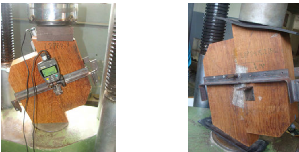
Figura C.2. Ensaio de corpos-de-prova ligação madeira-madeira, com duas peças de madeira, com conectores de concreto.
