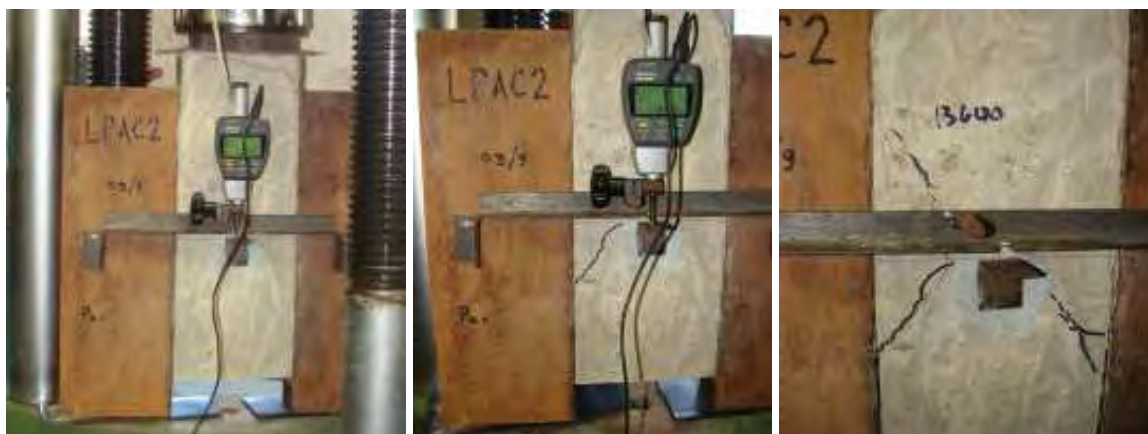
Figura 3.10. Ensaio de corpo-de-prova com conector em arco colado (LPAC2), em diferentes estágios do carregamento.
