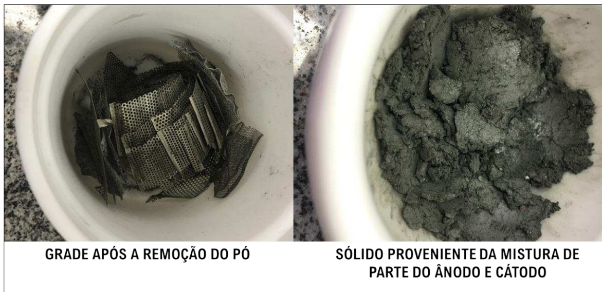
Figura 3. Foto das grades e sólido residual obtidos após o desmantelamento das baterias NiMH
