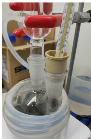
Figura 4. Sistema para lixiviação dos metais a partir das baterias de NiMH
