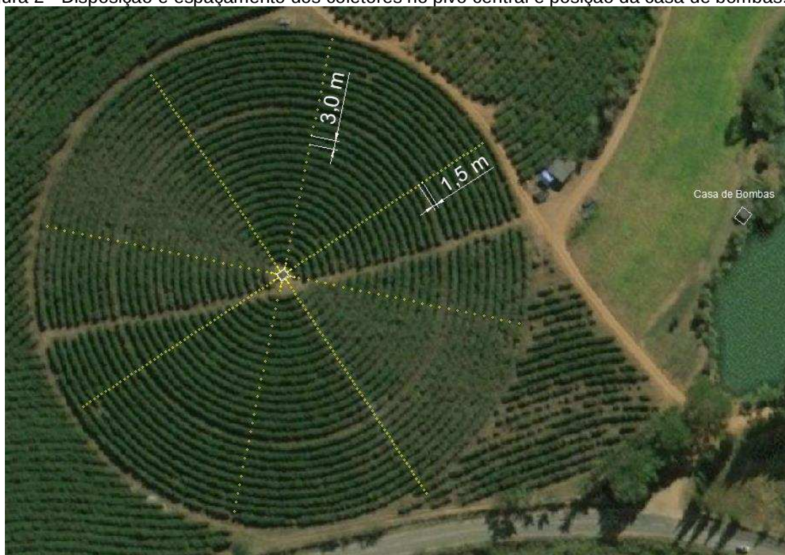
Figura 2 - Disposição e espaçamento dos coletores no pivô central e posição da casa de bombas.
