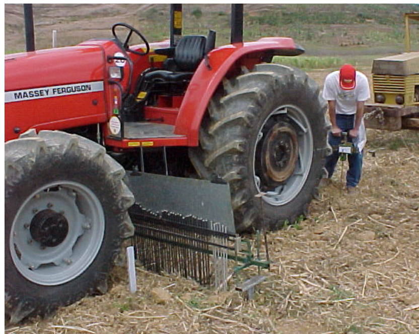
Figura 5 – Coleta das variáveis resistência à penetração (penetrógrafo) e deformação do solo (perfilômetro).
