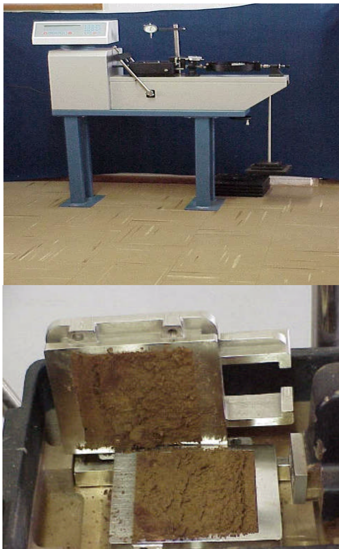
Figura 7 – Prensa para cisalhamento direto (Departamento de Ciência do Solo – Universidade Federal de Lavras) e amostra de solo cisalhada (ROCHA e DIAS JUNIOR, 2000).
