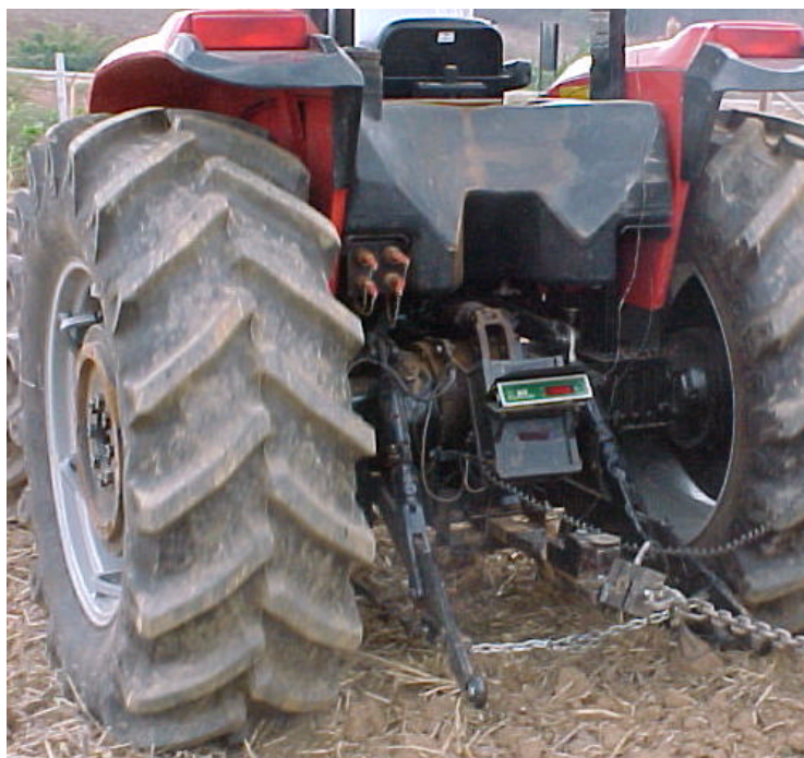
Figura 2 – Célula de carga e mostrador digital para medição de força na barra de tração.
