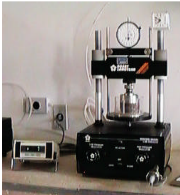
Figura 6 – Consolidômetro pneumático BOART Longyear (Departamento de Ciência do Solo – Universidade Federal de Lavras).
