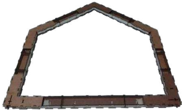
Figura 15 – Face frontal com laterais do pórtico.
