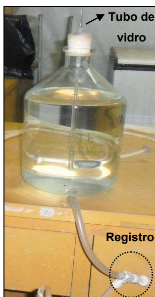
Figura 3.11 - Reservatório (frasco de Mariotte) utilizado no sistema
