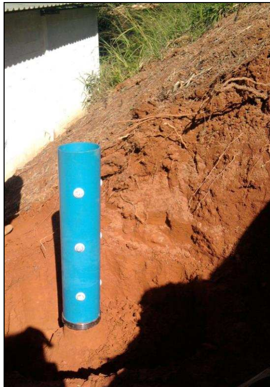
Figura 3.15 – Posicionamento da coluna acoplada ao anel biselado sobre a superfície do terreno
