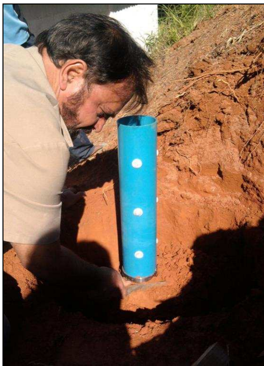
Figura 3.16 – Retirada do solo ao redor da coluna com auxílio de faca
