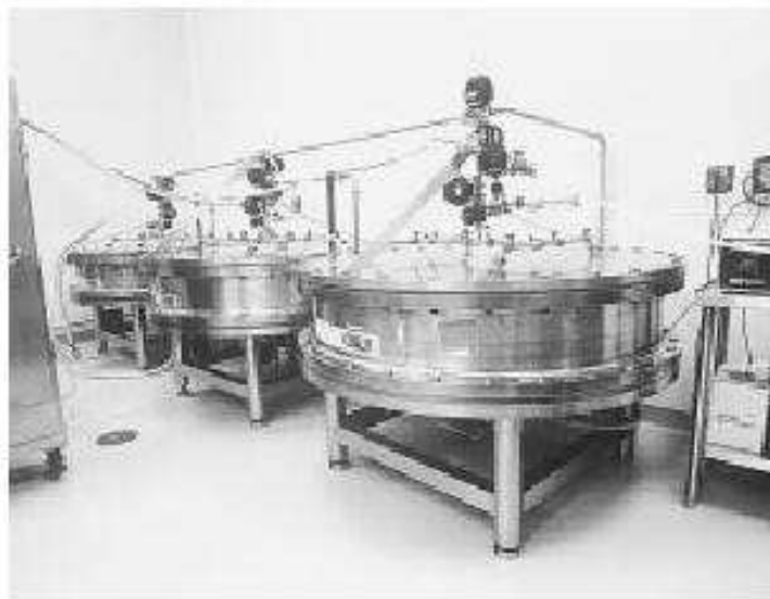
Figura 2.4 Fracionamento em nível industrial por filtração em gel usando três colunas (30 cm comprimento por 140 cm de diâmetro interno) conectadas em série; produção total de 1500 L. (PHARMACIA BIOTECH, 1998).
