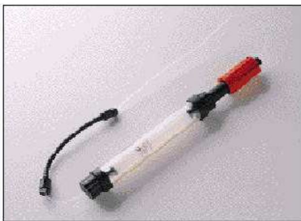
Figura 3.1 Coluna HR 10/10 empacotada com Shepadex® G-25
