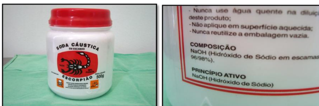
FIGURA 5 - Apresentação comercial da soda cáustica disponível para uso doméstico. Em destaque informações contidas no rótulo acerca do princípio ativo, composição, grau de pureza e forma de apresentação do produto.
