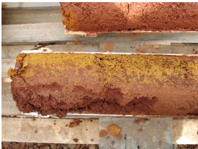
Figura 8. Precipitado sobre a superfície de módulo SOLO+RO do T5.
