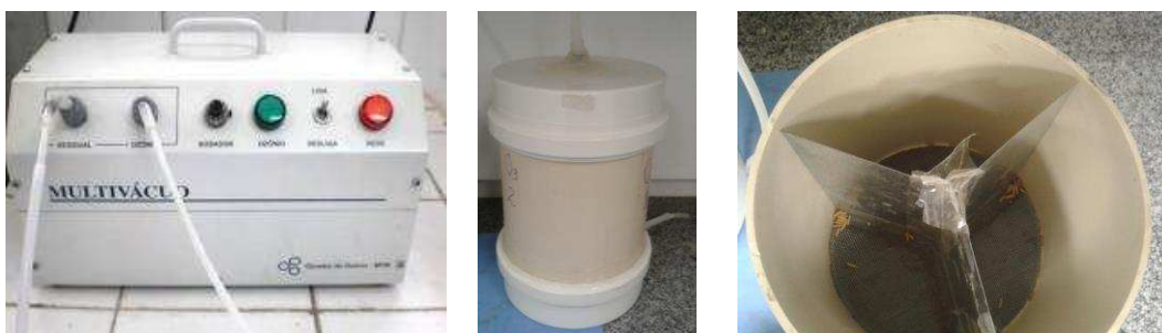
Figura 2 - Gerador de ozônio e câmara de fumigação utilizados na fumigação dos grãos de arroz com o gás ozônio.
