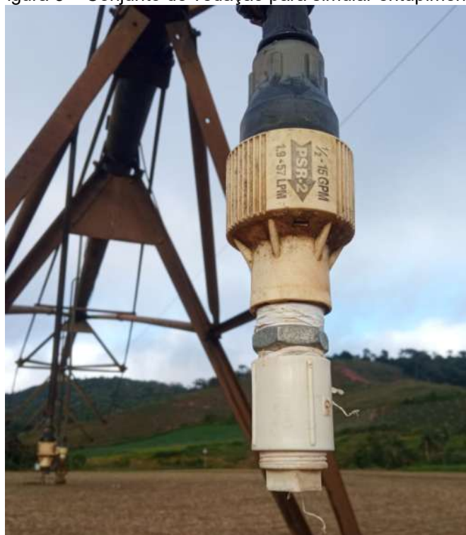
Figura 5 – Conjunto de vedação para simular entupimento
