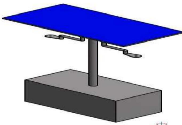
Figura 2.13 - Árvore Solar com um único módulo FV
