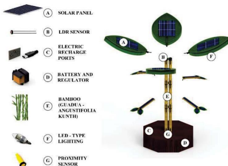
Figura 2.5 - Projeto de árvore solar com tronco feito de bambu
