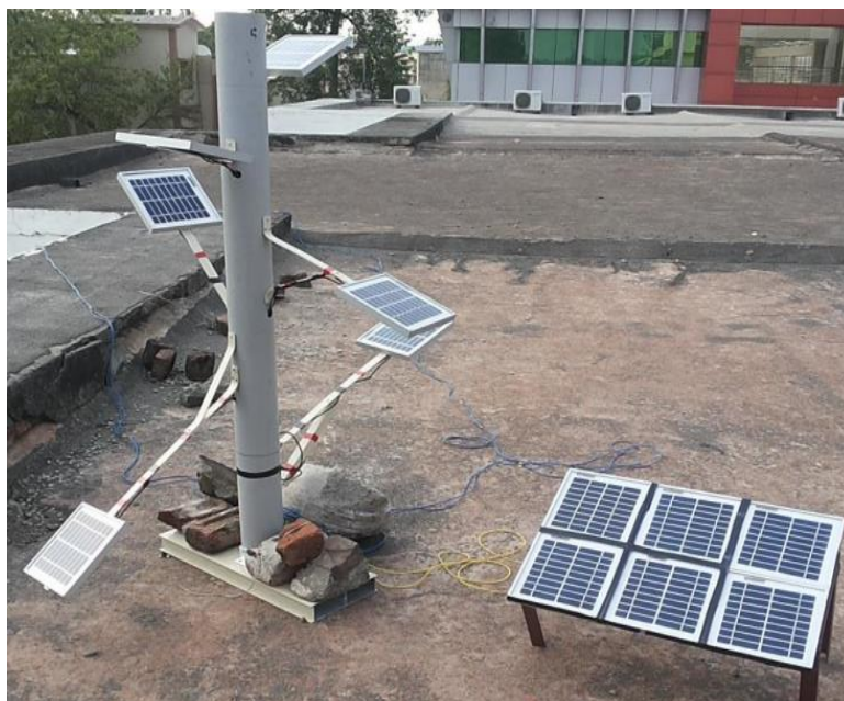
Figura 2.10 - Árvore solar e sistema tradicional com inclinação fixa, ambos com 6 células solares
