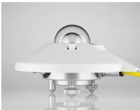
Figura 4.4 - Piranômetro da marca Kipp & Zonen, modelo CMP6, utilizado durante os experimentos
