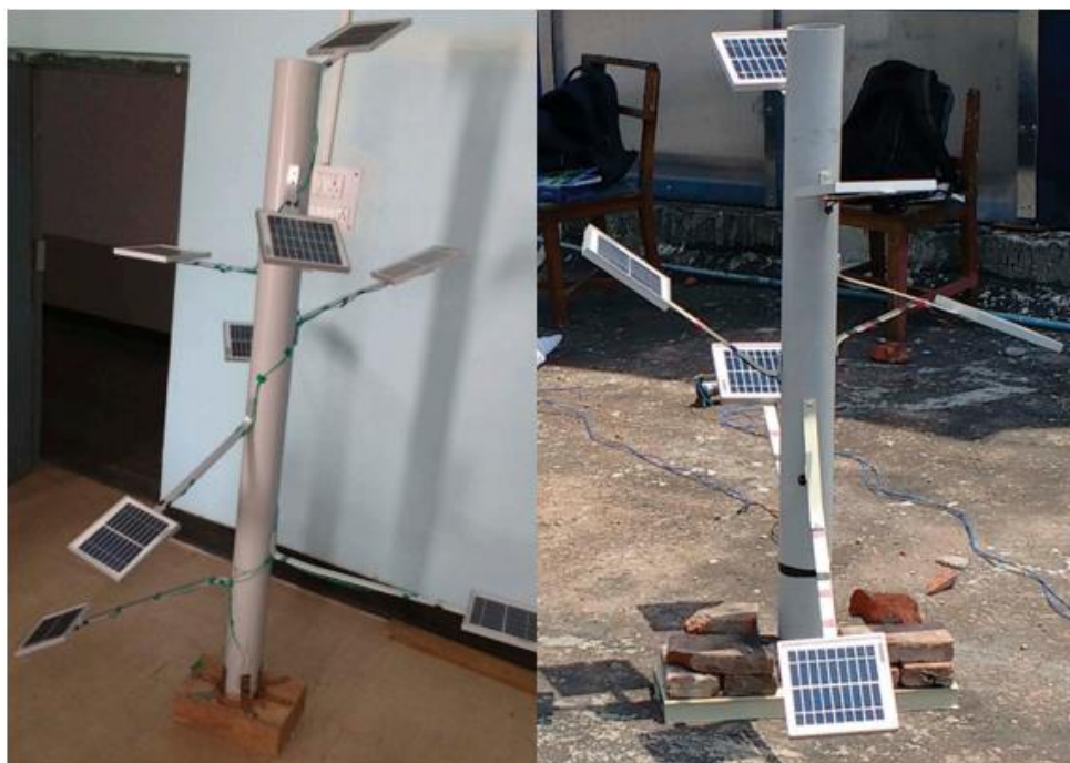
Figura 2.9 - Árvore solar (a) com 8 células solares; (b) com 6 células solares
