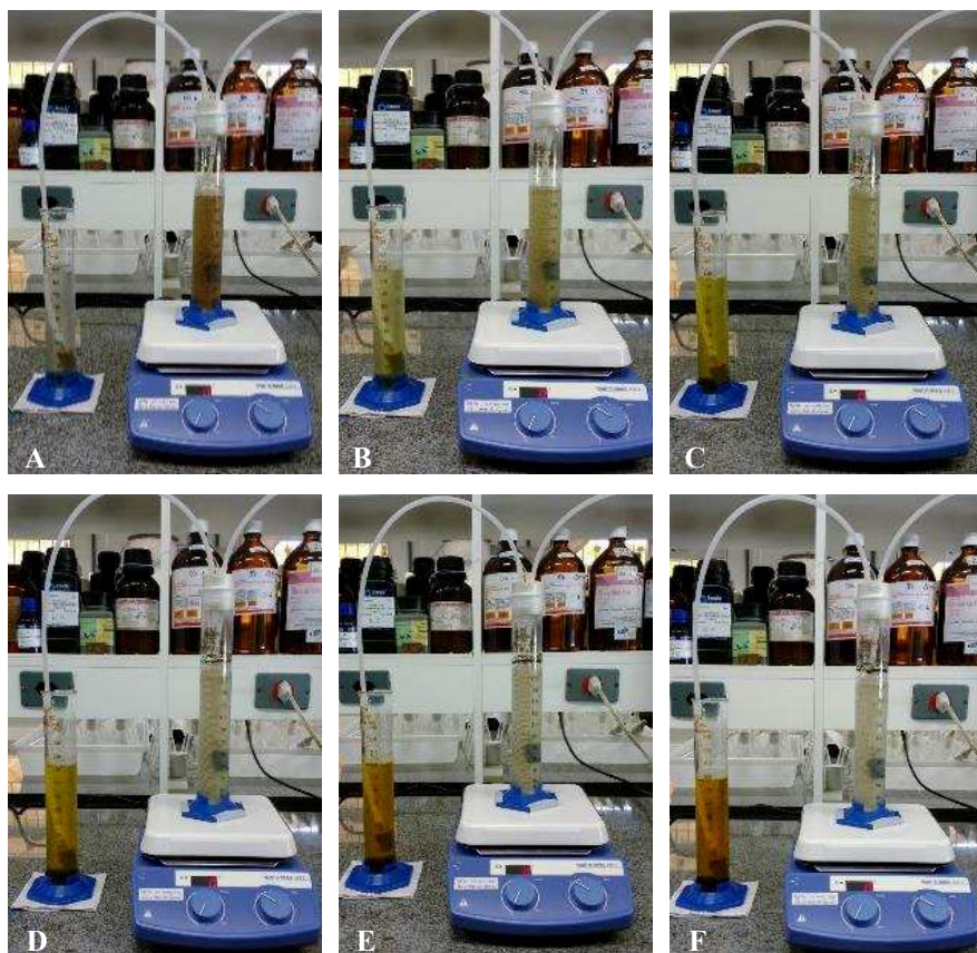
Figure 3: Ozonation process of culture supernatant: (A) 0 min, (B) 10 min, (C) 20 min, (D) 30 min, (E) 40 min and (F) 50 min.
