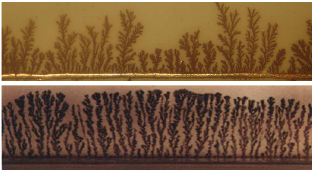
Figura 29 - Padrão formado durante eletro-cristalização de ferro a partir de uma solução de C=0,1 mol/l de FeCl_3 – (a) \Delta V = 5,0 volts; (b) \Delta V = 7,0 volts;
