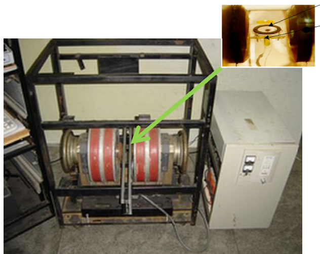
Figura 12 - Vista do eletroímã posicionado para a aplicação do campo magnético paralelo ao eixo da célula
