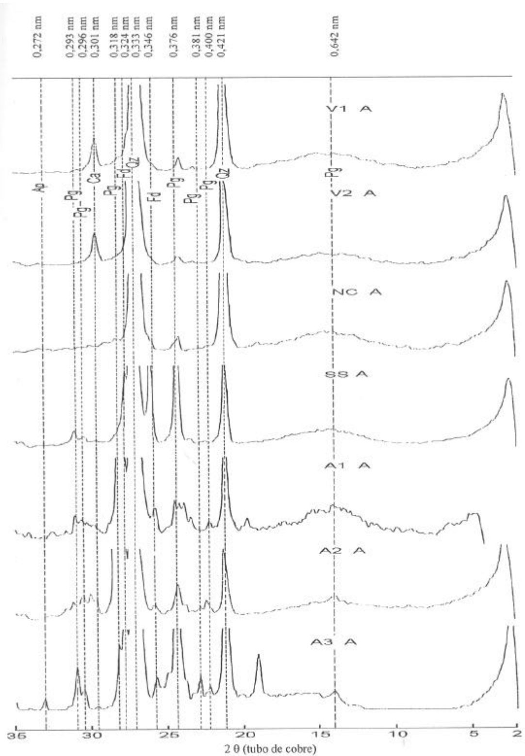
Figura 5 - Difratoigramas de raios X da fração areia grossa do horizonte superficial (A) dos solos estudados (lâminas não-orientadas). (Qz-quartzo; Pg-plagioclásio; Fd-feldspato; Ca-calcita; Ap-carbonato apatita).
