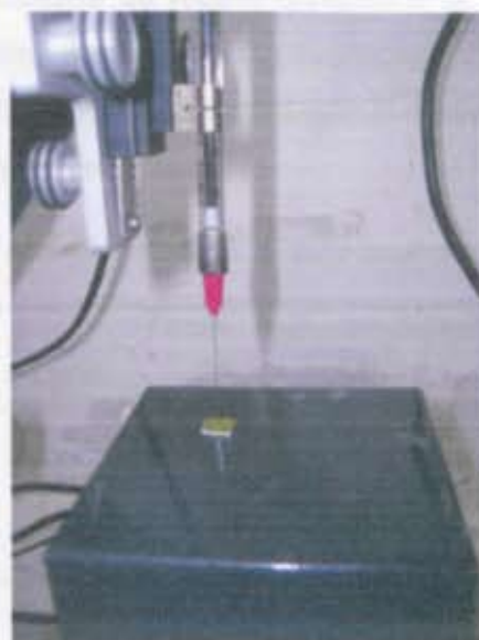
Figura 5: Medição dos ângulos de contato na superfície de alface
