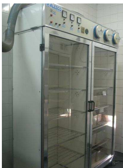
Figura 34- Estante ventilada (sala 10).
