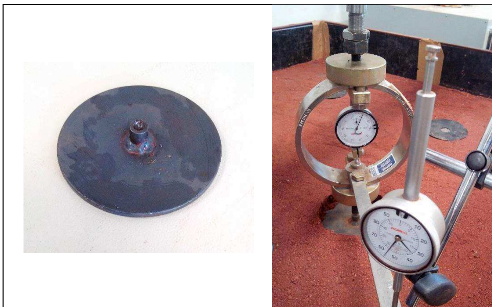
Figura 7.6: placa metálica rígida de diâmetro igual a 12 cm, utilizada para simular uma sapata e sistema de aplicação de carga com anel dinamométrico e medida de deslocamento por meio de relógio comparador.
