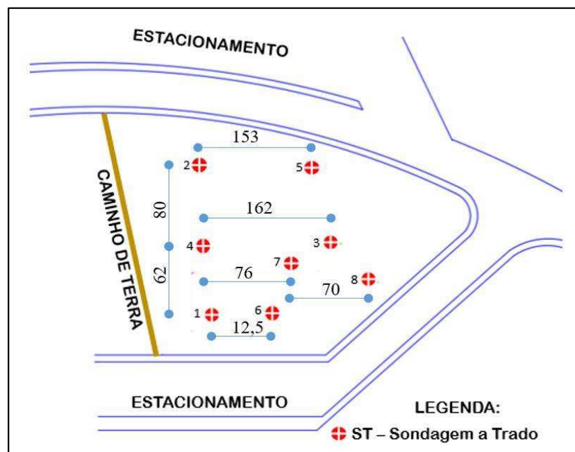
Figura 3.3: Campo Experimental, com localização dos 8 furos de sondagem de simples reconhecimento a trado, distâncias em metro e sem escala.
