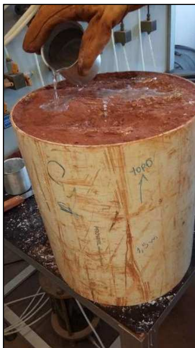
Figura 3.10: Preparação de amostra indeformada, no laboratório.
