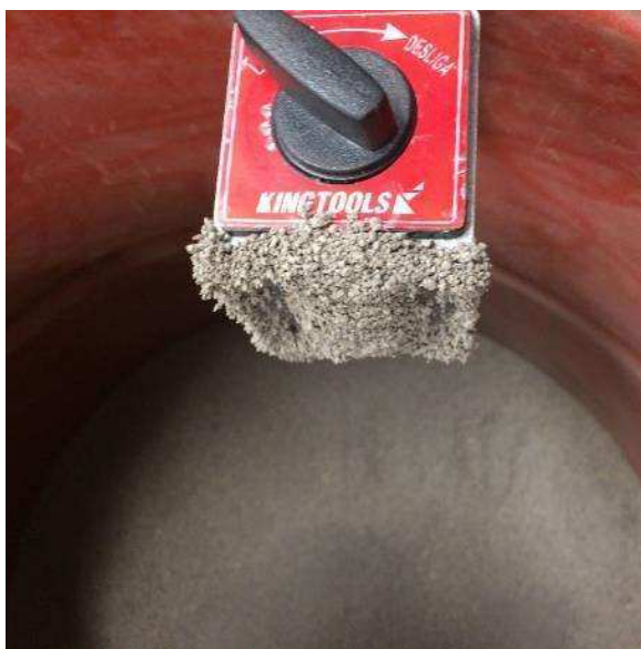
Figura 2.2: Base magnética, encoberta por escória reduzida granulometricamente, devido a atração magnética entre a base e minerais metálicos presentes na escória. Fonte: Autor.
