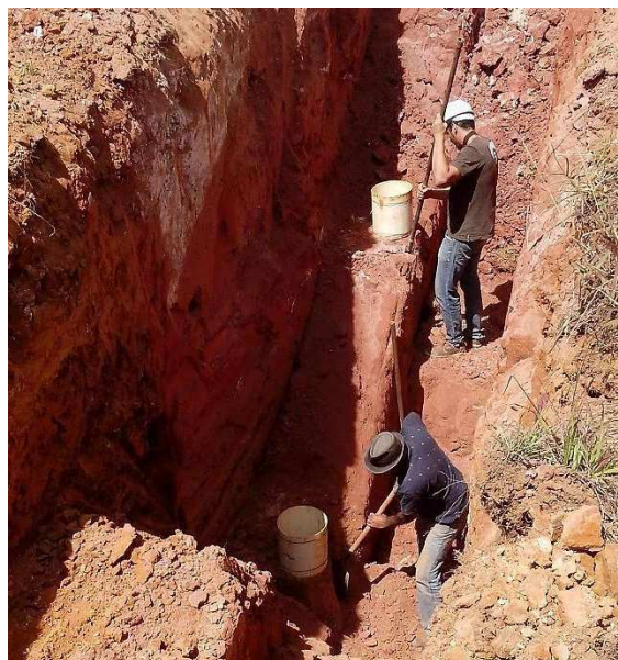
Figura 6.4: Retirada de amostras indeformadas em duas profundidades.
