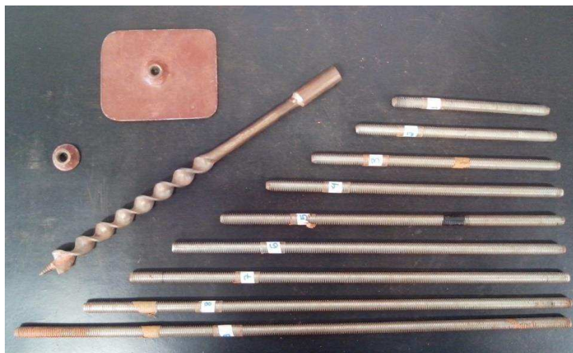
Figura 7.4: Equipamentos utilizados para confecção das estacas.
