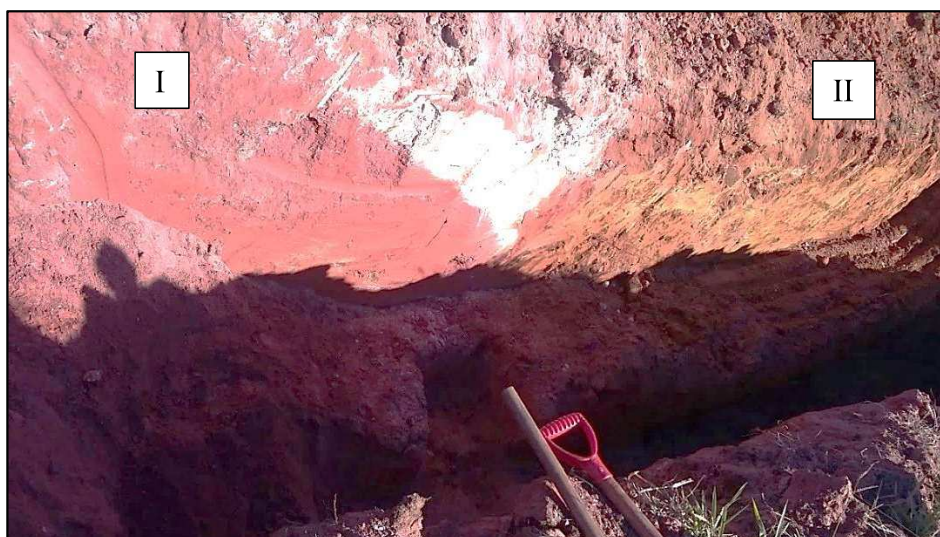
Figura 3.8: Trincheira apresentando variação do tipo de solo, representados pelas unidades Geotécnicas I e II.
