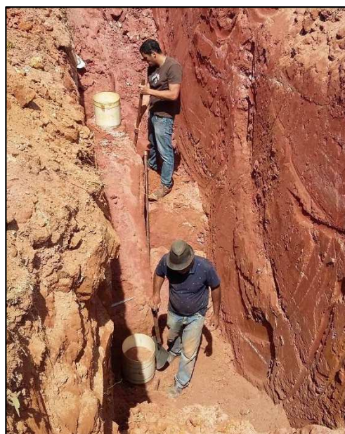
Figura 3.9: Retirada de amostras indeformadas em duas profundidades.
