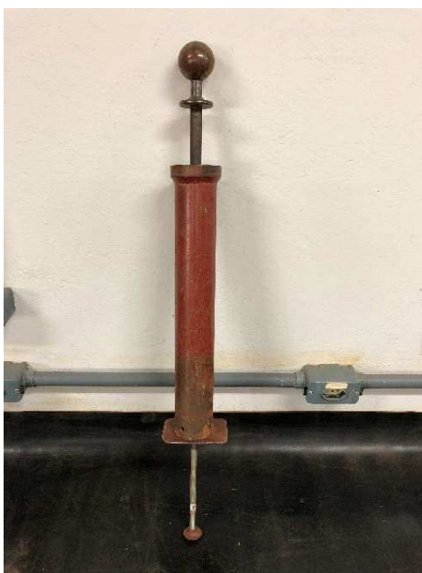
Figura 7.5: Esquema detalhando, haste rosqueada na ponta a uma base circular metálica com diâmetro próximo ao da estaca e no seu topo há uma base retangular metálica que recebe ação do soquete proctor.
