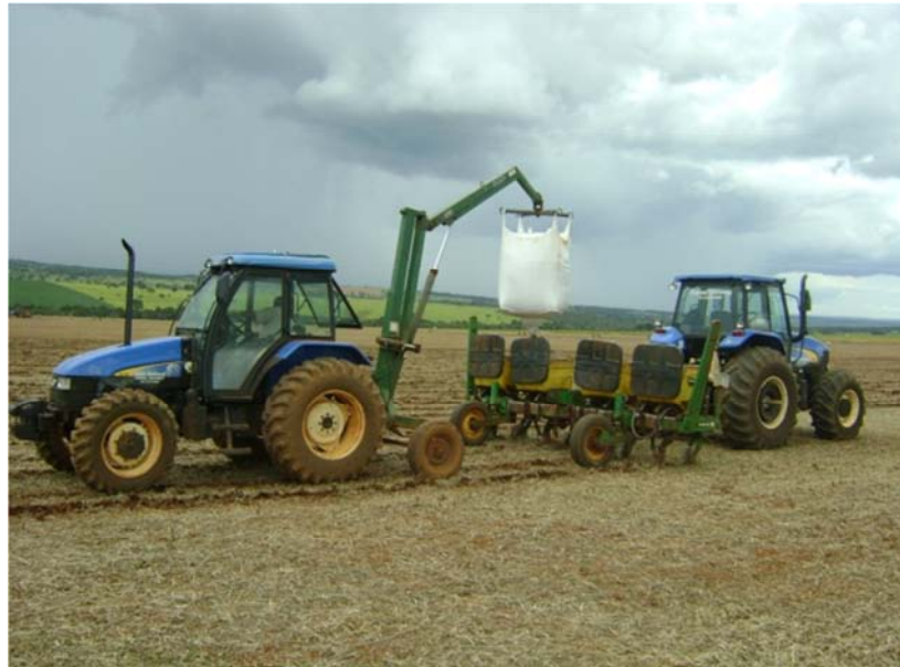
Figura 2. Conjunto mecanizado empregado no processo de abastecimento de fertilizantes.
