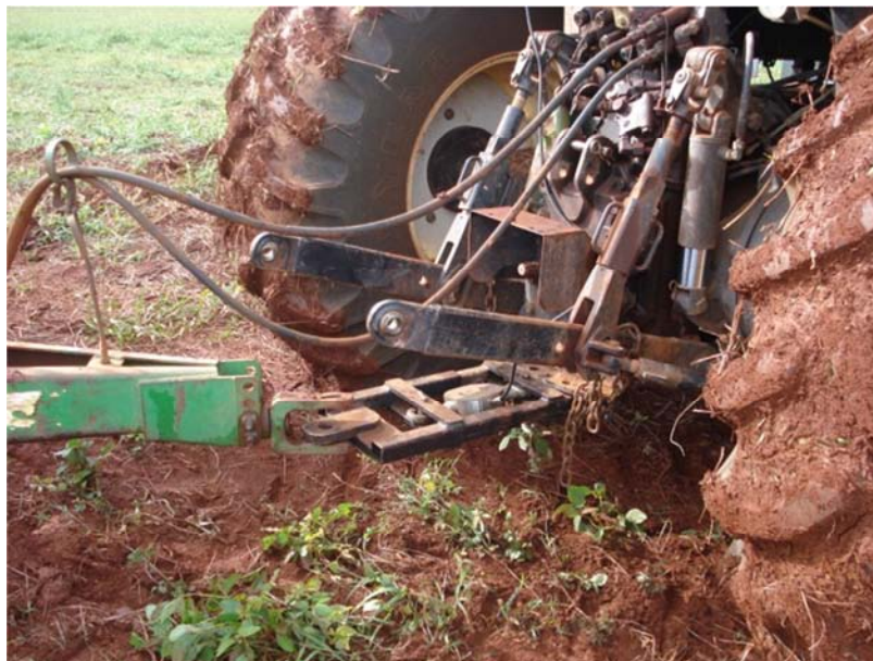
Figura 3. Célula de carga instalada no conjunto mecanizado.
