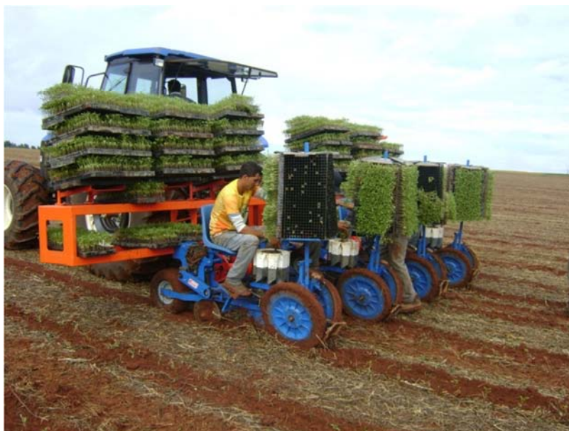
Figura 1. Conjunto mecanizado de transplântio, trator e transplantadora com quatro unidades de transplântio.
