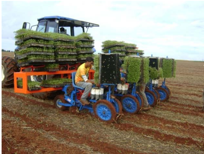
Figura 2. Conjunto mecanizado empregado para o transplântio.
