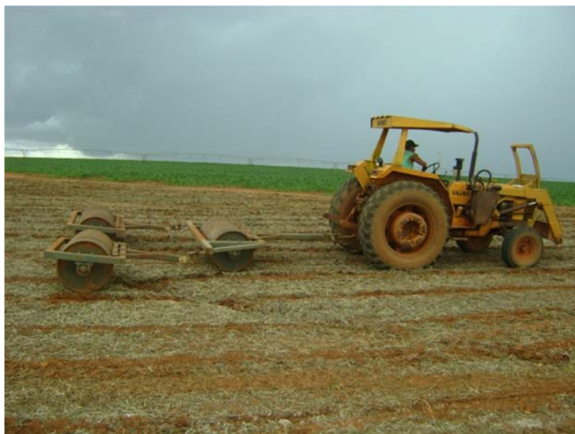
Figura 3. Conjunto mecanizado utilizado para as operações de compactação e destorroamento.
