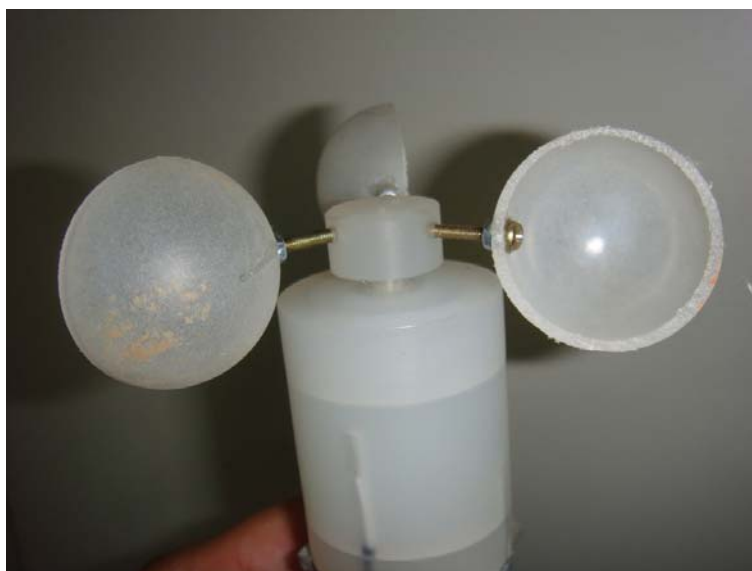
Figura 8 – Anemômetro desenvolvido no experimento.
