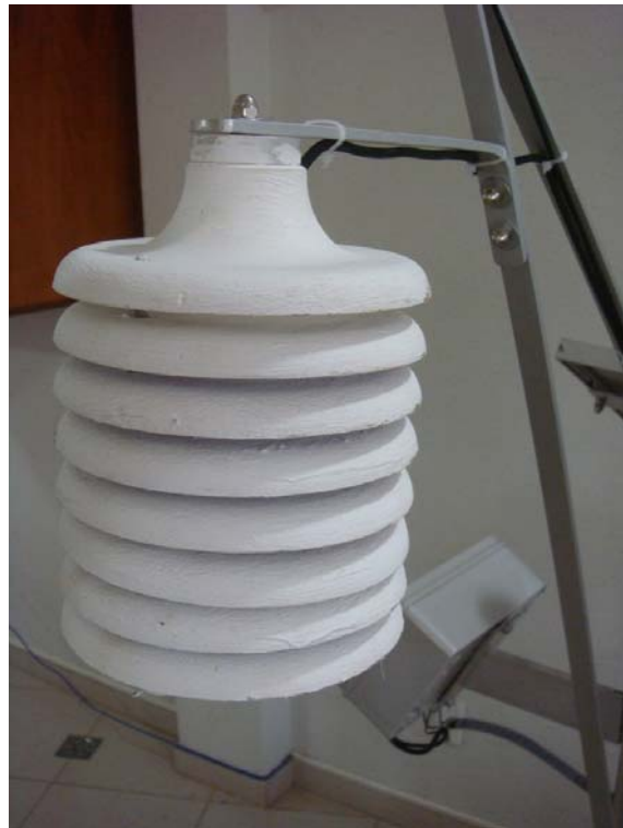
Figura 6 – Abrigo termométrico desenvolvido no experimento.
