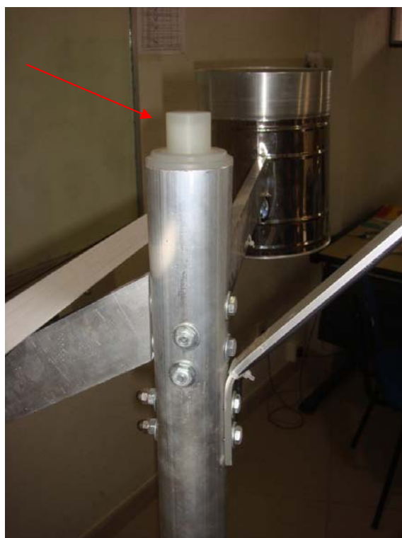
Figura 7 – Piranômetro desenvolvido no experimento.
