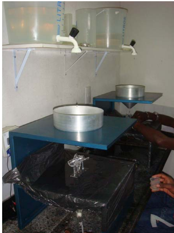
Figura 22 – Calibração do pluviômetro desenvolvido.
