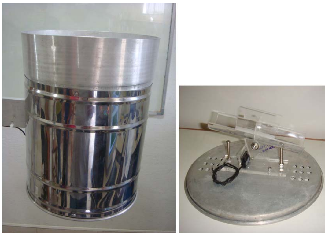
Figura 10 – Pluviômetro desenvolvido no experimento com detalhe na báscula.
