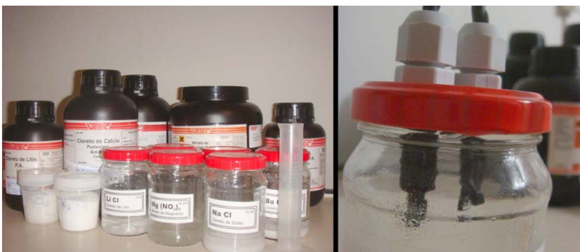
Figura 21 - Aferição do higrômetro desenvolvido.
