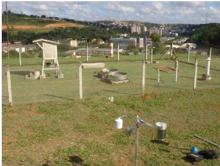
Figura 25 – Instalação da EMA desenvolvida ao lado da estação meteorológica convencional.
