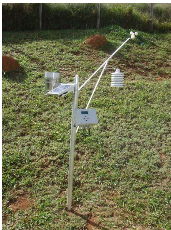
Figura 16 – EMA desenvolvida com destaque para o posicionamento dos sensores.
