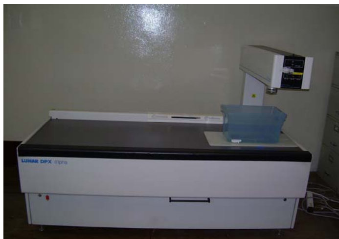
Figura 2. Densitômetro LUNAR- DPX-ALPHA utilizado para mensuração da densidade mineral óssea do fêmur dos ratos após hipocinesia, treinamento e mantidos sem tratamento experimental.
