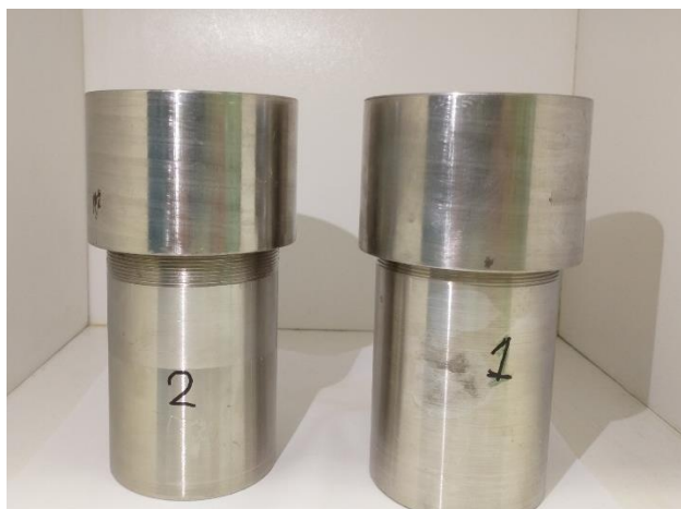
Figura 2.1. Reatores autoclave utilizados no presente trabalho. Fonte: o autor.
