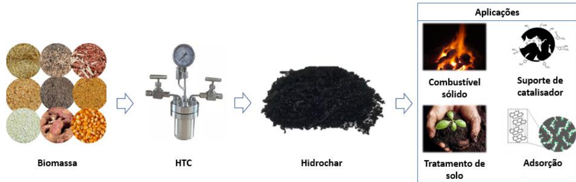
Figura 1.14. Potenciais aplicações do hidrochar produzido a partir de biomassa residual. Fonte: o autor.
